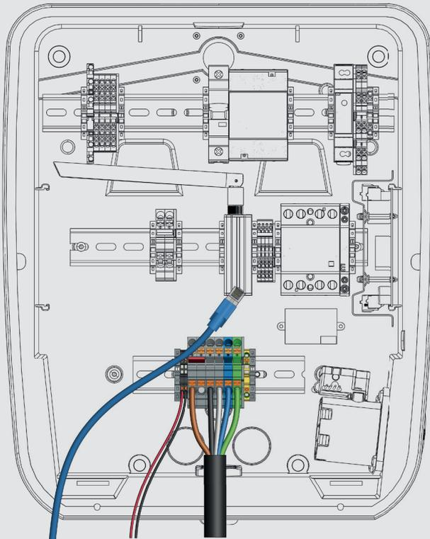
Ethernet Anschluss    EVU Sperre    Zuleitung
