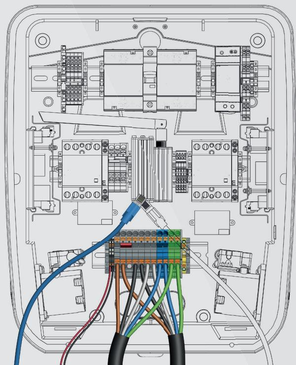
Ethernet Anschluss    EVU Sperre    Zuleitung 1    Zuleitung 2    Daisy Chain (für weitere Stationen)
